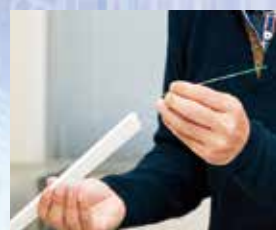
プラスチックのカバー×光ファイバーを用いて、写真上に相当するミュオグラフィ検出器を製作中。
