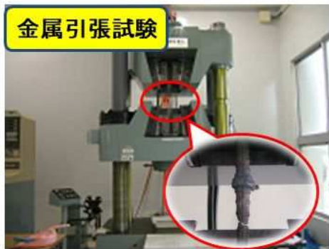
最大引張荷重 2000 kN (最大異形棒 D51)
