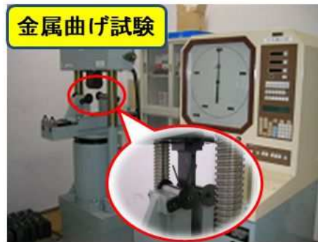
最大曲げ荷重 1000 kN (最大異形棒 D51)
