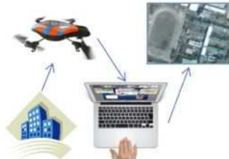
カメラ搭載型ヘリを自動操縦して撮影し断片画像から航空写真を作る技術
