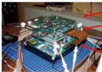
図2 ACモータの制御系の構成
