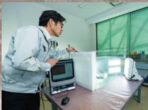
画像解析：ハイスピードカメラで泡の様子を観察・検証。3Dプリンターで装置を手作りすることで、学生たちの理解がより深まるメリットもある。
