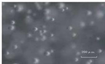
図1 マイクロバブルの拡大写真
