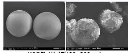
**成果** • 構造体のpH低下をトリガーに物質を放出するMCを開発中
