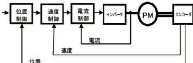
図2 ACモータの制御系の構成
