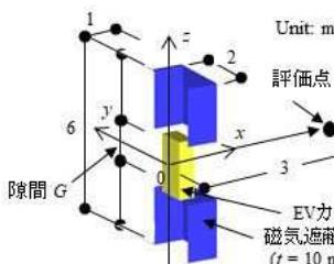
(a)磁気遮蔽材に隙間設置 (b) 磁気遮蔽材に庇設置
