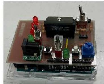
マイコン(Arduino)実験用拡張シールドの製作
