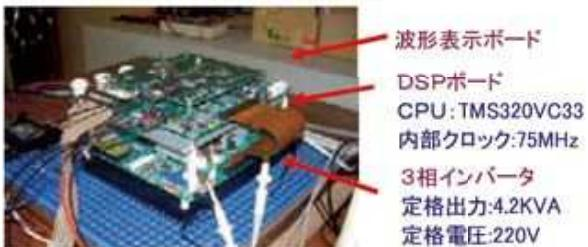
図3 インバータと制御ボード
