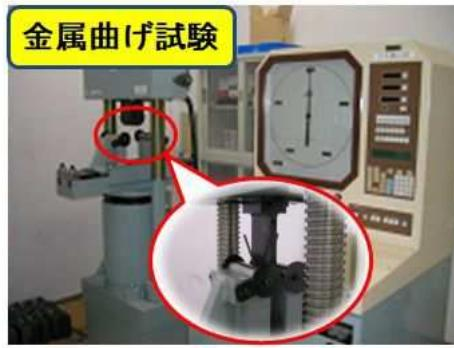
最大曲げ荷重 1000 kN
