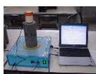
動弾性係数を測定し、コンクリート供試体の強度推定等を行う装置
