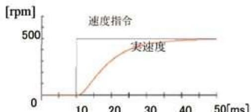
図5 シミュレーション波形
