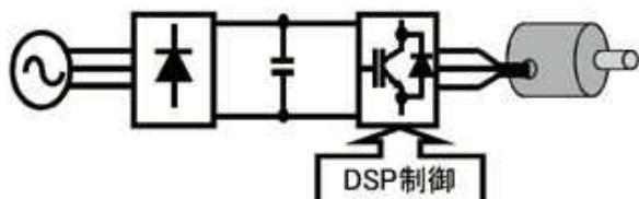
図1 ACモータのインバータ駆動システム
