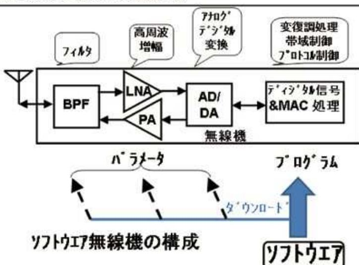
BPF : Band Pass Filter, LNA: Low Noise Amplifier, PA: Power Amplifier
