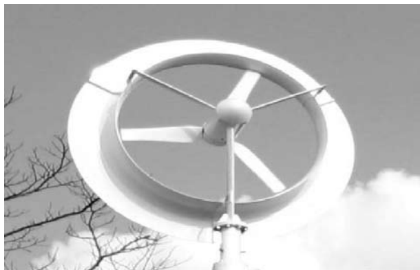
写真 九州大学春日キャンパスの風レンズ風車 同型が今年本校屋上に建設予定
