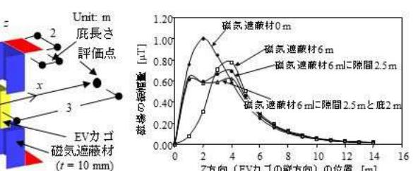
磁界強度分布( $x=3,000$ ,  $y=0$ )解析結果 Bx成分(水平方向)
