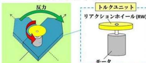
モータで RW を回転させ、その反力をによってリンクに直接トルクを与える装置
