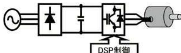
図1 ACモータのインバータ駆動システム
