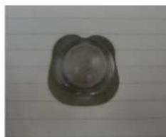
変形したbcc型Mg合金の様子
