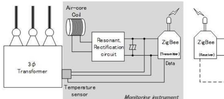
電力用変圧器周辺の磁界をハーベスティングして利用した変圧器温度観測装置
