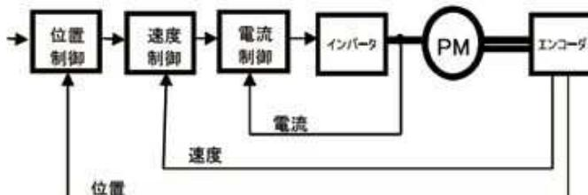
図2 ACモータの制御系の構成
