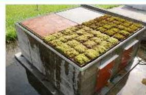
**成果** ・ 吸水状態の苔緑化材を屋上に設置した場合、緑化材自体の温度上昇を抑制、日射熱による屋内への熱の流入をほぼ1日中防ぐことができる。
