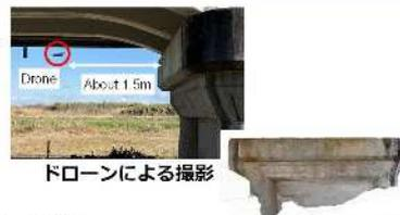
**成果** ・ **ひび割れ幅0.2mm以上**であれば精度よく検出可能
