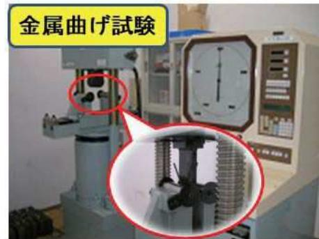
最大曲げ荷重 1000 kN
