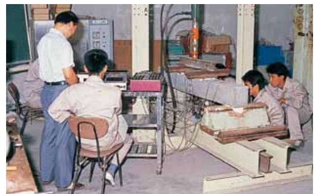
鉄筋コンクリートはりの曲げ強度試験 Test of bending strength for reinforced concrete beam
