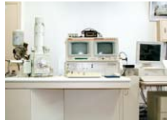
エネルギー分散型 X 線分析装置・走査電子顕微鏡 Energy Dispersive X-ray Microanalyzer・Scanning Electron Microscope
