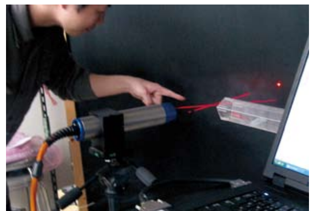
レーザードップラー流速計を用いた噴流の速度計測 Velocity Measurement of Jet Flow Using Laser Doppler Velocimetry
