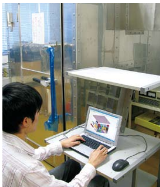
磁性体角筒を併用した MRI 用オープンタイプ磁気シールドルームの検討 Open Type of Magnetically Shielded Room Combined with Square Cylinders made by Magnetic Material for MRI
