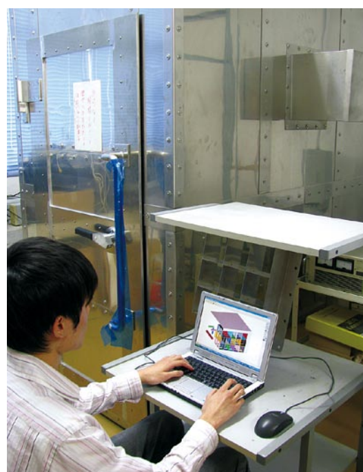
磁性体角筒を併用した MRI 用オープンタイプ磁気シールドルームの検討
