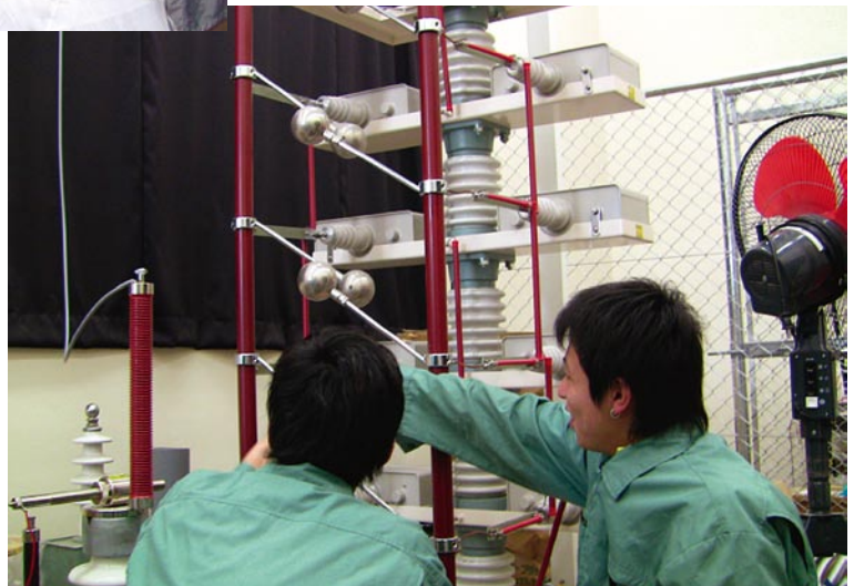
高電圧インパルス発生試験(人工雷の生成) Experiments of high voltage impulse generation (Artificial lightning generation)
