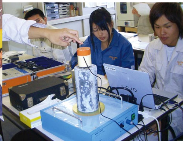
コンクリートの弾性係数測定 Concrete Elastic Modulus Measurement
