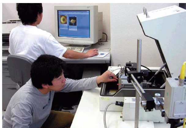
走査型プローブ顕微鏡による生体材料の観察 Observation of Biological Materials by Scanning Probe Microscopy
