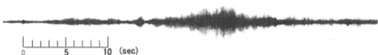
図-8. パイプロプレート通過時の地盤振動の時間的推移 (Geophone)
