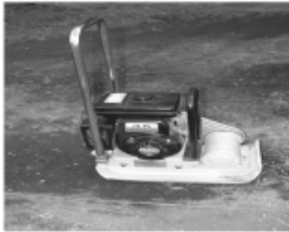
写真-7. パイプロプレート
