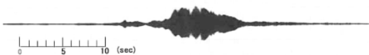
図-7. パイプロプレート通過時の地盤振動の時間的推移 (1軸加速度計)
