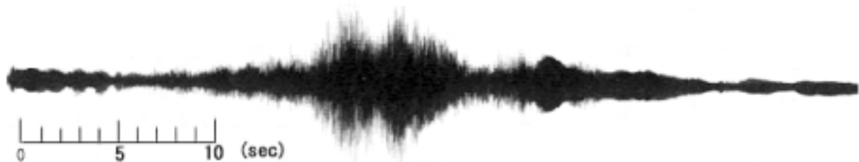
図-6. パイプロプレート通過時の地盤振動の時間的推移 (3軸加速度計)
