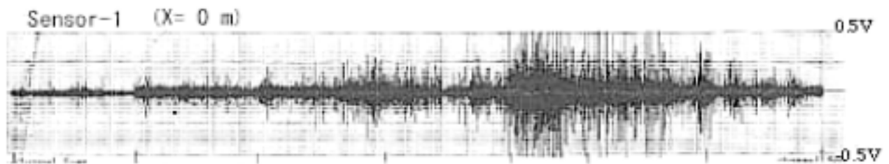
図-5. 土石流通過時の地盤振動の時間的推移 (野尻川, 1997.9.16)
