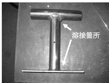
図2 円筒鋼管の溶接
