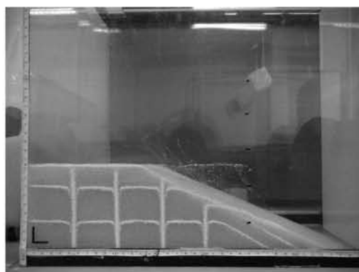
図 3-6 積層高さ 100mm の崩壊状態
