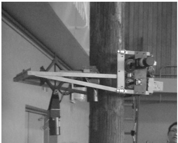
図3 3D/CADで作成したロボット組立図(左)と樹木昇降中のロボット(右)
