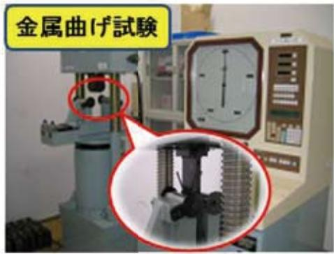
最大曲げ荷重 1000 kN
