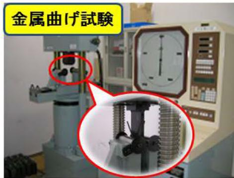
最大曲げ荷重 1000 kN
