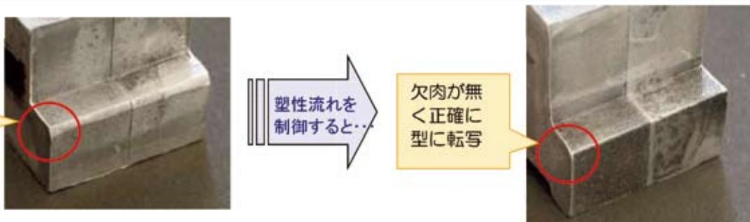
企業メリット • 製品品質を高めると同時に生産コストを下げるネットシェイプ型鍛造部品の製造
