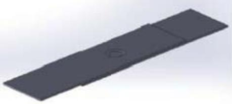
超音波接合された板の3Dモデル
