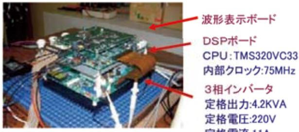
図3 インバータと制御ボード
