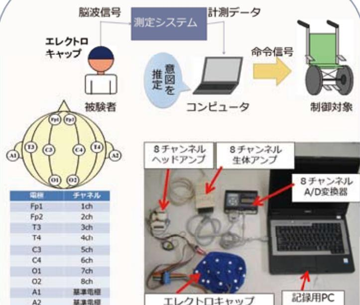
図1 国際10-20法に基づく電極の配置
