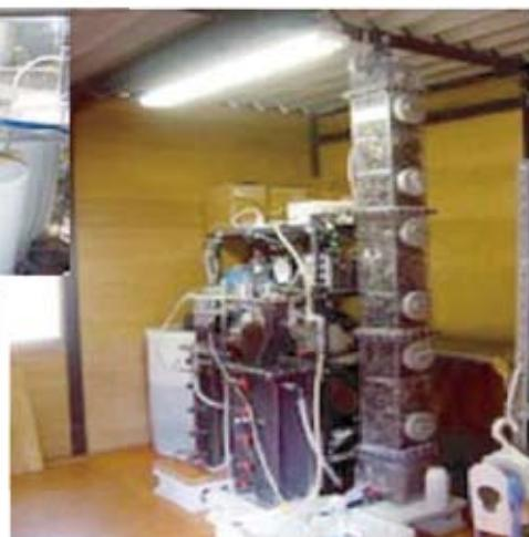
焼酎蒸留廃水を高速メタン発酵していた多段型高温UASB実験プラント（写真左）
