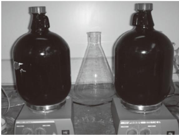
図 2.4 脱窒実験装置(回分式)
