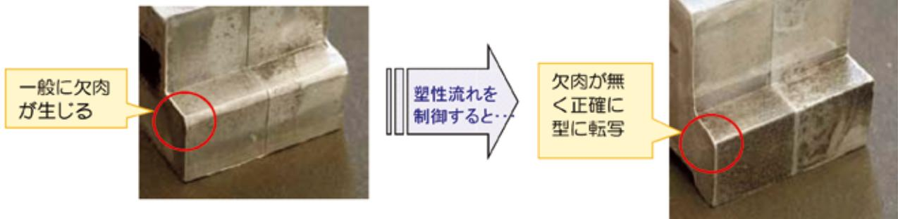
企業メリット ・製品品質を高めると同時に生産コストを下げるネットシェイプ型鍛造部品の製造
