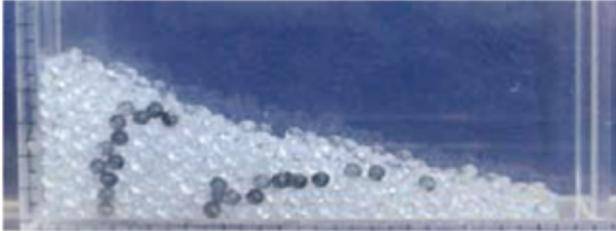
図1 粒体として直径5mmのガラスビーズを用いて崩壊実験を行った結果
