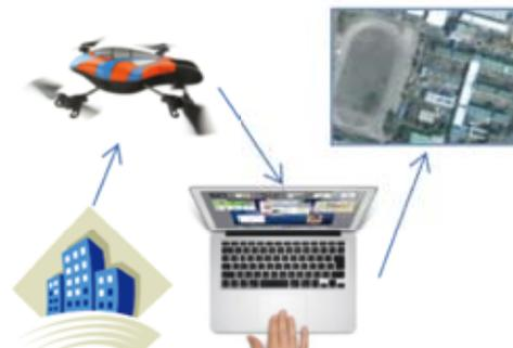
カメラ搭載型ヘリを自動操縦して撮影し断片画像から航空写真を作る技術
