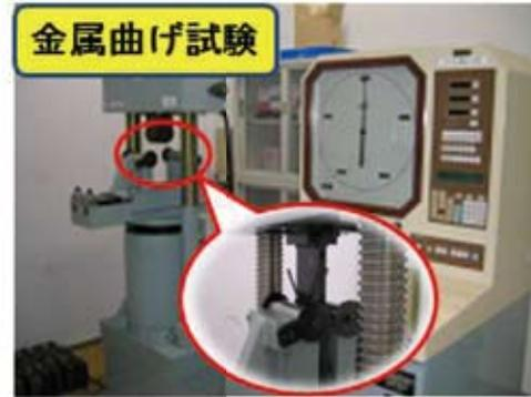
最大曲げ荷重 1000 kN
