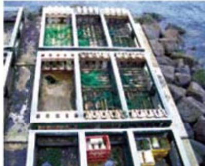
コンクリートの海洋暴露実験施設
