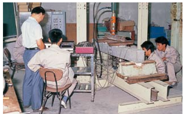
鉄筋コンクリートはりの曲げ強度試験 Test of bending strength for reinforced concrete beam
