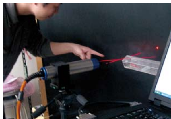
レーザードップラー流速計を用いた噴流の速度計測 Velocity Measurement of Jet Flow Using Laser Doppler Velocimetry
