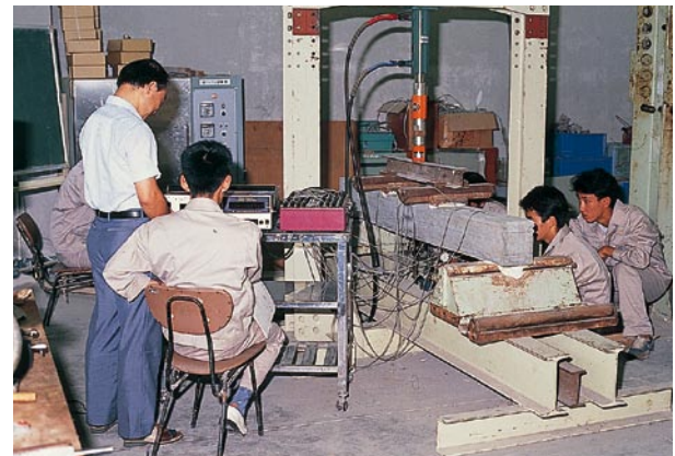
鉄筋コンクリートはりの曲げ強度試験 Test of bending strength for reinforced concrete beam
