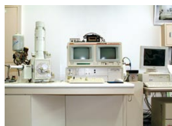
エネルギー分散型 X 線分析装置・走査電子顕微鏡 Energy Dispersive X-ray Microanalyzer・Scanning Electron Microscope
