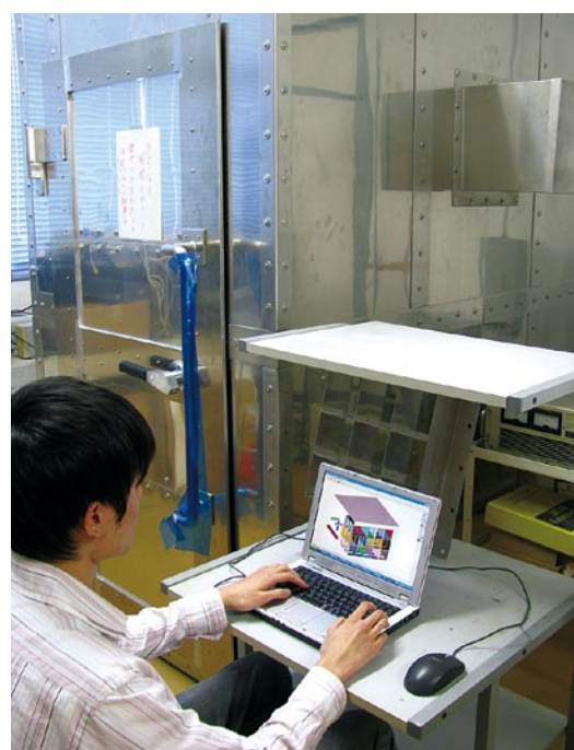
磁性体角筒を併用した MRI 用オープンタイプ磁気シールドルームの検討 Open Type of Magnetically Shielded Room Combined with Square Cylinders made by Magnetic Material for MRI
