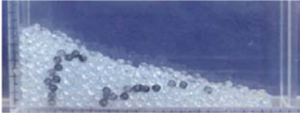
図1 粒体として直径5mmのガラスビーズを用いて崩壊実験を行った結果
