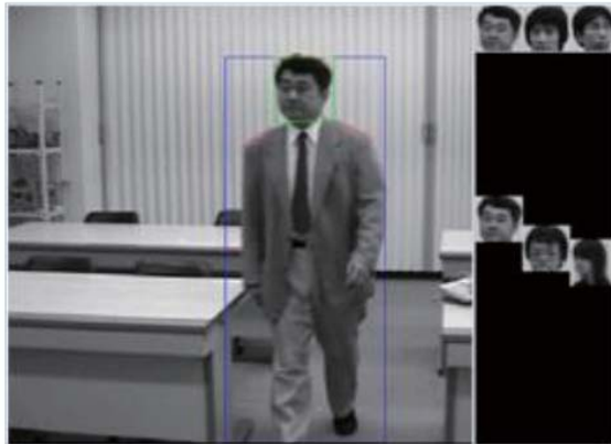
人物の身長等の外見情報をカメラ視野内滞留中に取得蓄積し、確率的手法にて人物同定を行う技術
