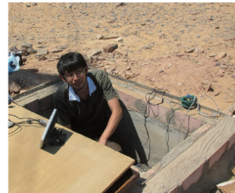
磁力計設置作業（アスワン）
