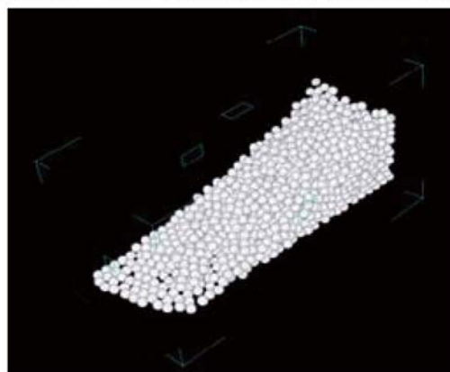
図3 マイクロX線CTによる崩壊状態の粒子の3次元画像(自己組織化臨界状態)
